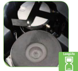
搭載高扭力齒輪箱馬達及高效率層三層風碟吸水馬達
